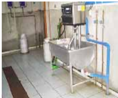
Foto 1.1. Detergentes y desinfectantes utilizados en el lavado de equipos de ordeña y sistema de lavado automático de equipo de ordeña.
