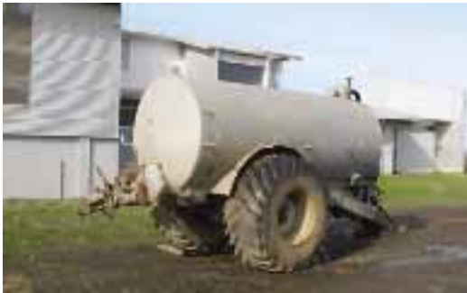
Foto 5.19. Carros accionados por vacío.
