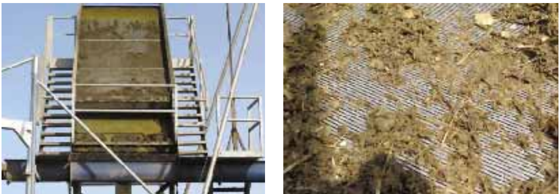
Foto 5.27. Separador de mallas y detalle de la malla.
