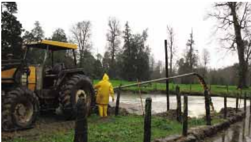
Foto 5.9. Mezclado con la propia bomba purinera por recirculación.
