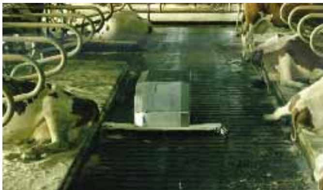
Foto 5.5. Raspador tipo robot a control remoto.
