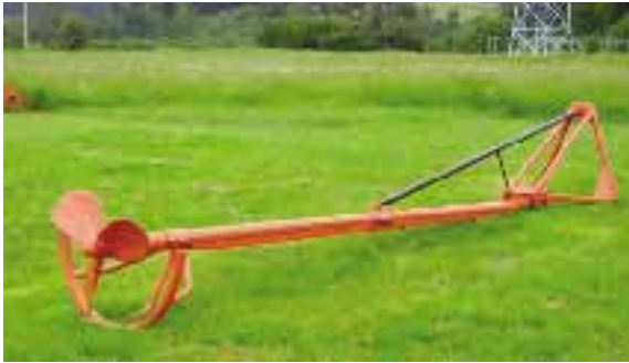
Foto 5.7. Agitadores de purín tipo hélice.
