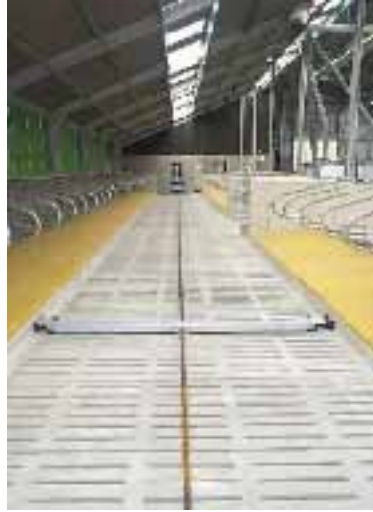
Foto 5.4. Raspador con cable sobre piso de concreto.
