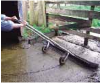
Foto 5.1. Distintos tipos de raspadores con ruedas.
