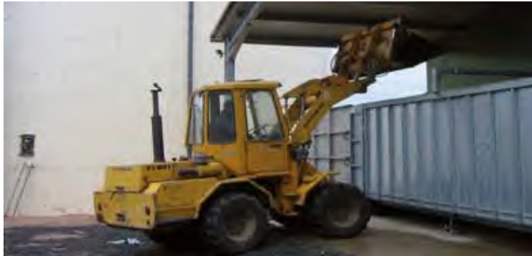
Figura 11: Carga del contenedor dosificador de sustrato
