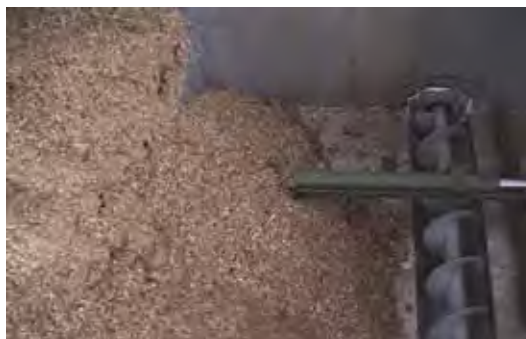
Figura 14: Sistema de alimentación con estanque externo y cargador frontal
